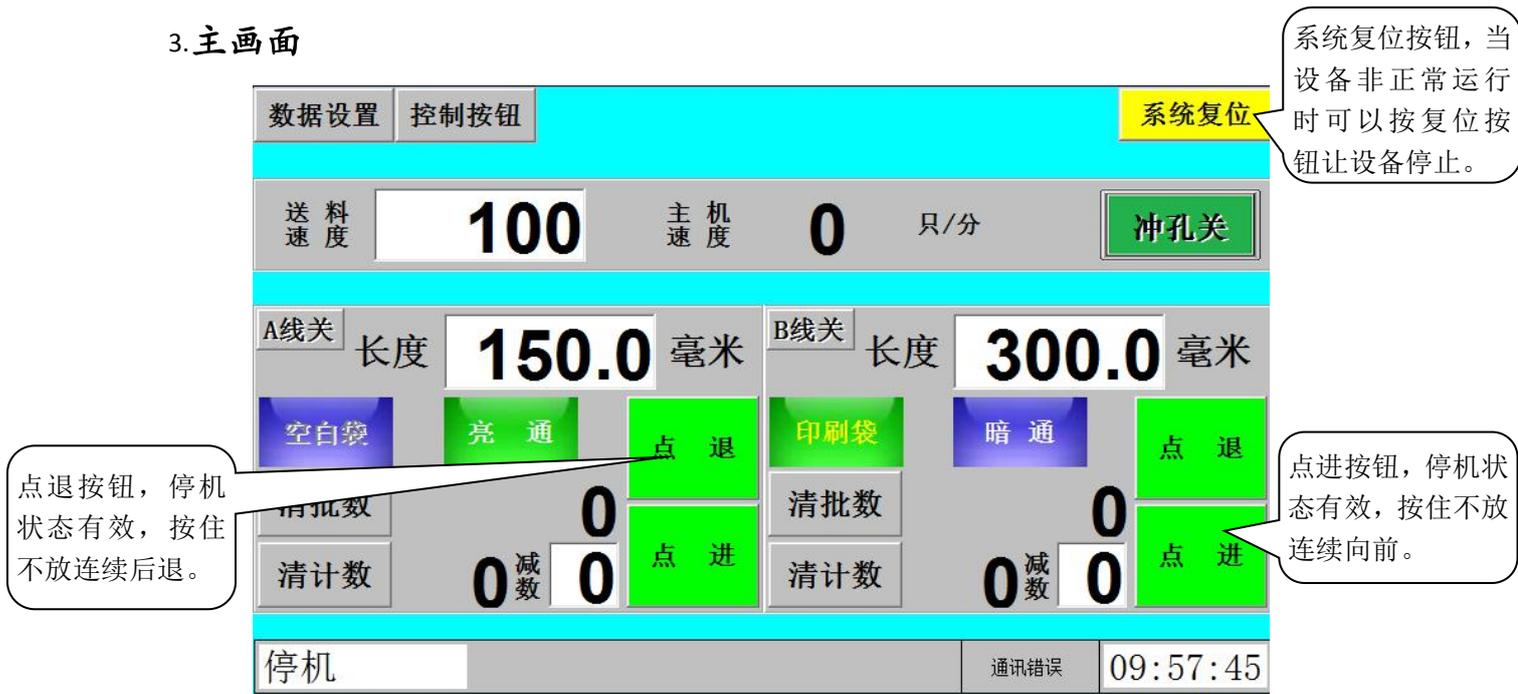
3.1 **数据设置**按钮, 使用数据设置按钮可以将显示画面切换到数据设置画面, 在数据设置画面可以对机器的**常用、润滑、系统**等数据进行设置。关于数据设置画面的说明请参考“4.数据设置”。
