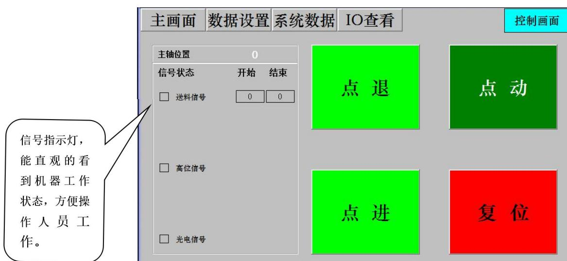
5.1 **主画面** 按钮，使用数据设置按钮可以将显示画面切换到主画面，在主画面可以对**长度、送料速度、空白袋/印刷袋**等进行设置，还可以进行**清计数、清批数、设备点进点退、设备复位**等进行操作。关于数据设置画面的说明请参考“3.主画面”。
